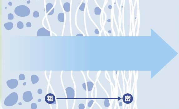
疎密一体構造型ろ材を使用しており、塵埃の保持容量を向上しています。さらに、流出側は機械的に繊維を編みこみ、高密度化させることで、ろ材抵抗を高めることなく、除去効率を向上しております。
