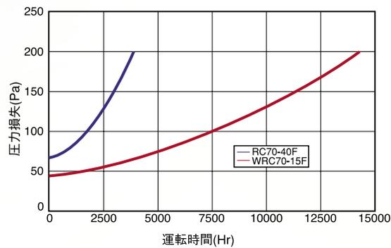
運転時間算出条件 ●粉塵濃度：0.15mg/m<sup>3</sup>
